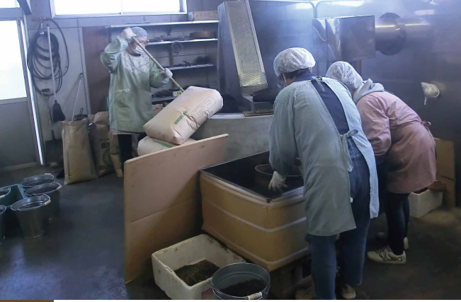
松の薪を燃料にして、国内でも珍しい炎が円形にまわっていく古式構造の炉の上に平釜を設置して焙煎を行う。
