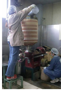
ねじ式の搾油機で、圧力をかけ菜種をつぶして油を搾り出す。
