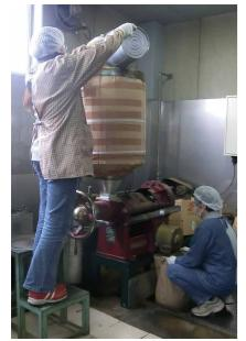
ねじ式の圧搾機で、圧力をかけ菜種をつぶして油を搾り出す。
