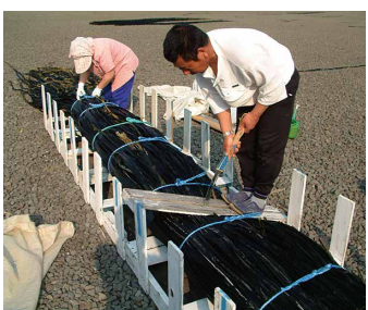
乾燥後は基準に従って選定し、105cmの長さに裁断する。
