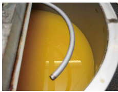
原油に脱酸処理をして、遊離脂肪酸を除去し、油を酸化しにくくする。
