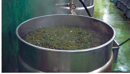
安田食品工業では、小さめの釜で少量を炊きあげ、味、歯切れ、色艶などの均一化をはかる。
