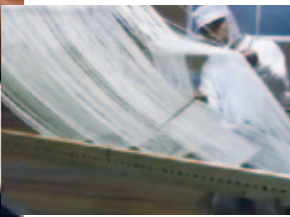
製法の特徴となる「足踏み」の作業。その日の気温や湿度により微妙に変わる麺生地の状態を足に伝わる感覚で把握しながら、麺の弾力をつくるために足で踏み込む。
