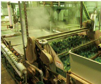
製茶工程の「蒸し」。茶葉を蒸気で蒸して、酸化酵素の働きを止める。「蒸し時間」が通常の2～3倍であるため「深蒸し」と呼ばれる。
