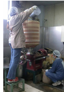
ねじ式の压榨機で、圧力をかけ菜種をつぶして油を搾り出す。
