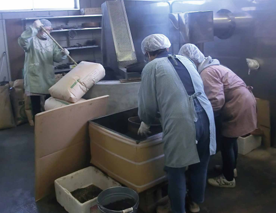
松の薪を燃料にして、国内でも珍しい炎が円形にまわっていく古式構造の炉の上に平釜を設置して焙煎を行う。
