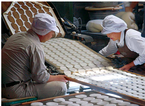
写真上/いけだ屋にて。機械で餅を同じ厚さに伸ばして型抜きする。型がきちんと抜けているかどうか、職人たちが目を光らせている。
