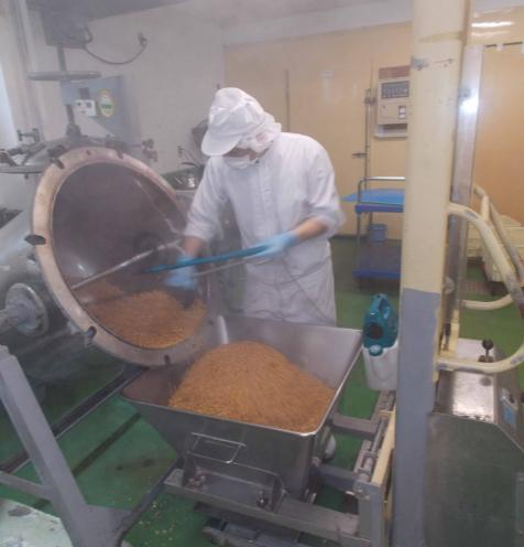
圧力蒸気により時間をかけ低圧蒸煮することで、弾力ある柔らかさの煮豆に
